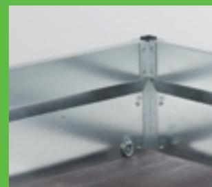
Anbindepunkte nicht in der Bodenplatte sondern an der Seitenwand. Der Vorteil: Optimale Ausnutzung der Ladefläche
