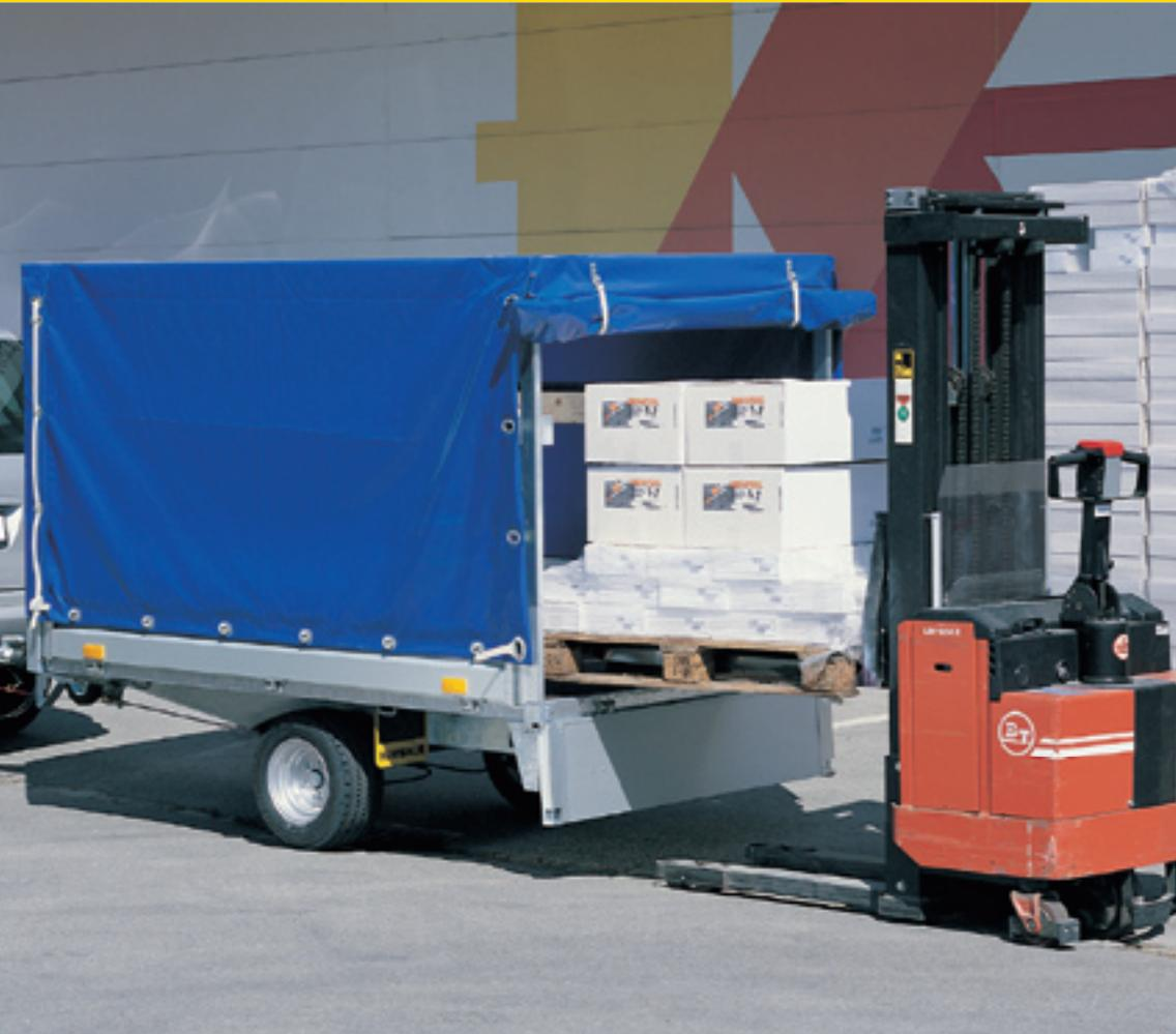
Bordwand aus doppelwandigem Aluminiumprofil, 25 mm stark
