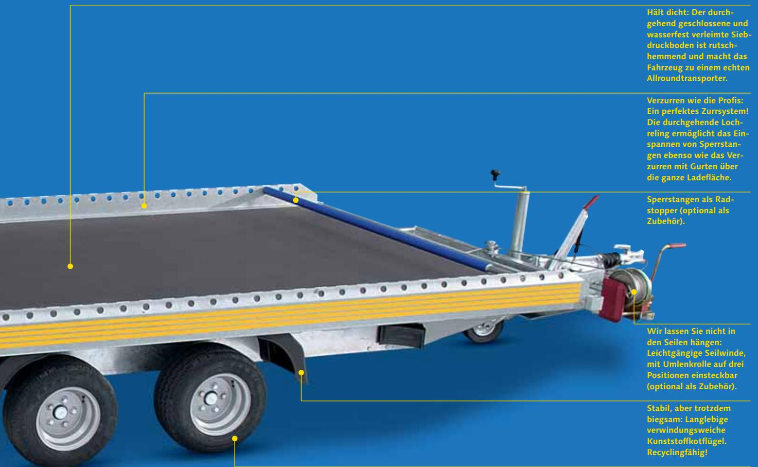
Hält dicht: Der durchgehend geschlossene und wasserfest verleimte Siebdruckboden ist rutschhemmend und macht das Fahrzeug zu einem echten Allroundtransporter.
