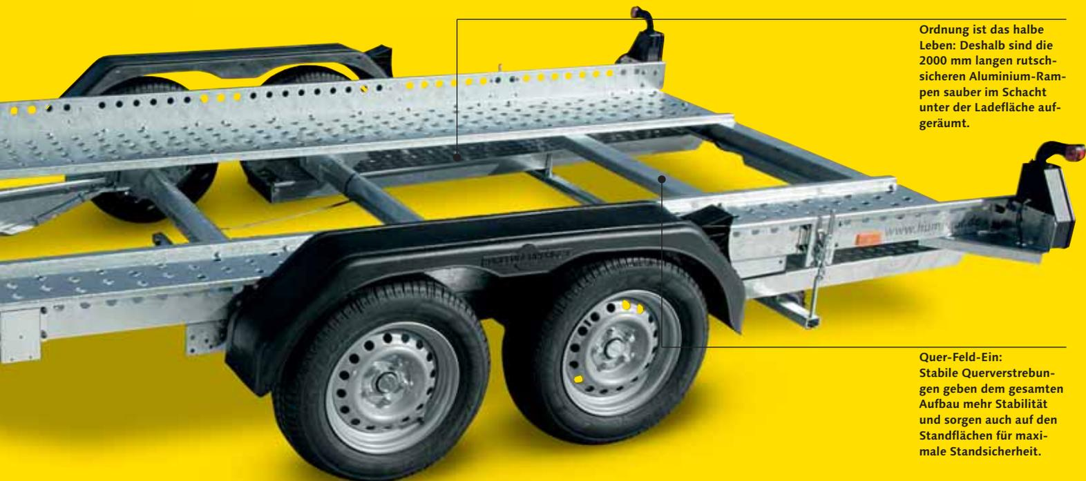
Quer-Feld-Ein: Stabile Querverstrebungen geben dem gesamten Aufbau mehr Stabilität und sorgen auch auf den Standflächen für maximale Standsicherheit.
