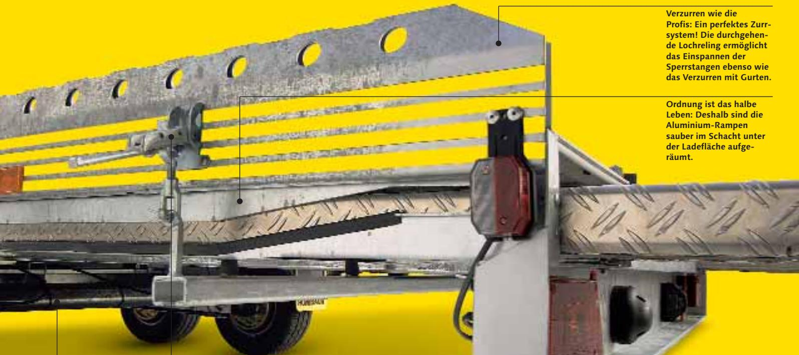
Verzurren wie die Profis: Ein perfektes Zurrsystem! Die durchgehende Lochreihung ermöglicht das Einspannen der Sperrstangen ebenso wie das Verzurren mit Gurten.
