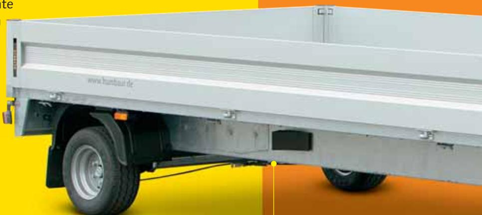
Massiver Leiterraum (LKW-Bauweise) kpl. feuerverzinkt mit Querstreben
