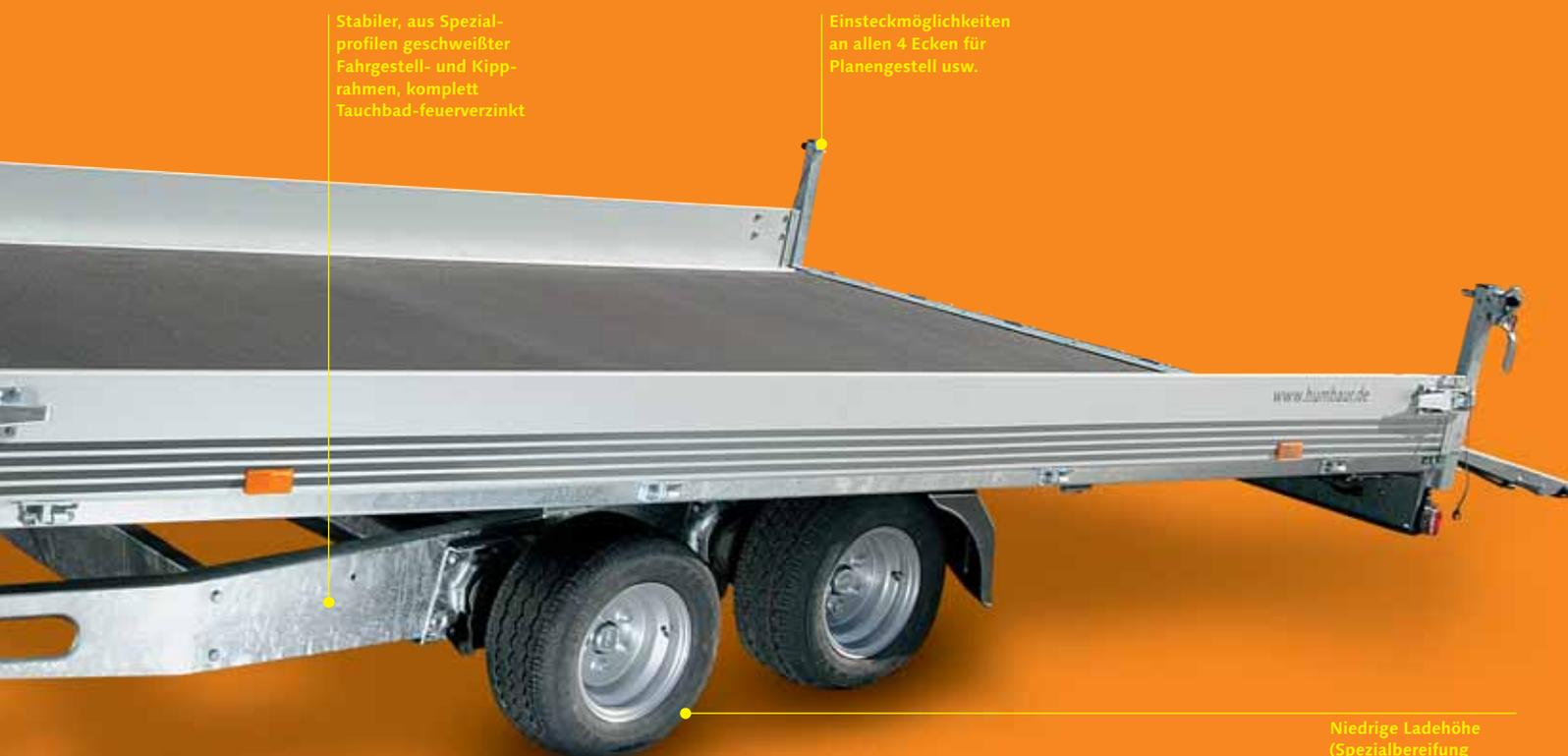
Stabiler, aus Spezialprofilen geschweißter Fahrgestell- und Kipprahmen, komplett Tauchbad-feuerverzinkt
