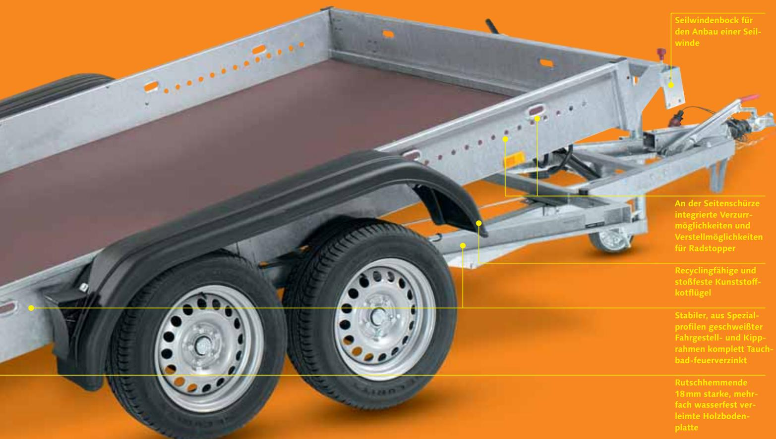
Seilwindenbock für den Anbau einer Seilwinde
