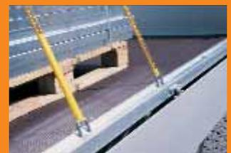
Massive Zurrbügel (liegen bei Nichtverwendung kpl. in der V-Zurrschiene), einfaches Beladen mit Gabelstapler etc. jederzeit möglich
