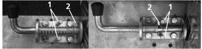
Drehtürverschluss geschlossen und geöffnet
