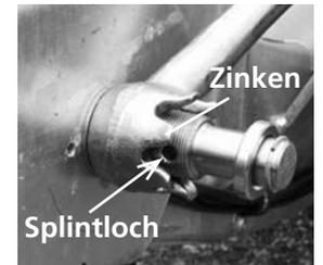
**Hebel mit Splint und Ausschnitt Splintloch**
