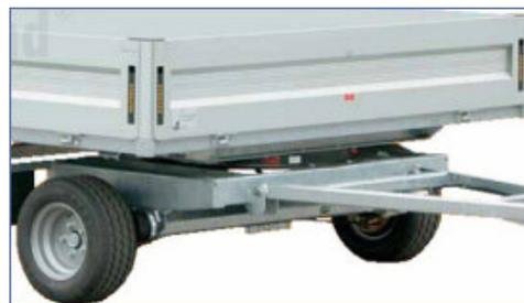
Der Drehschemel mit kugelgelagertem Drehkranz
