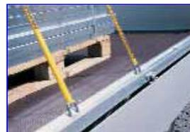
**Bei Humbaur Drehschemel-Anhängers: Massive Zurrbügel (liegen bei Nichtverwendung kpl. in der V-Zurrschiene), einfaches Beladen mit Gabelstapler etc. jederzeit möglich**
