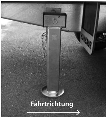
Kurbelstütze in Stützposition
