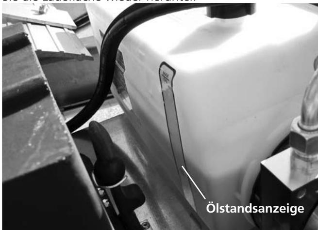
Ölstandsanzeige bei kombinierter Elektro- und Handpumpe
